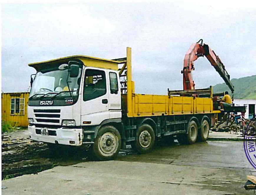
--- 吊臂貨車，5.5 噸 < 總重量 \leq 38 噸 Lorry with crane, 5.5 tonne < gross vehicle weight \leq 38 tonne
